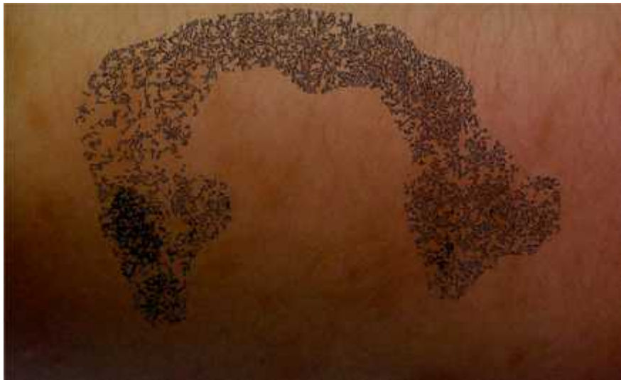
Figura 19. Filtro de Canny aplicado únicamente al área delimitada por el contorno que se observa en la Figura 17.
