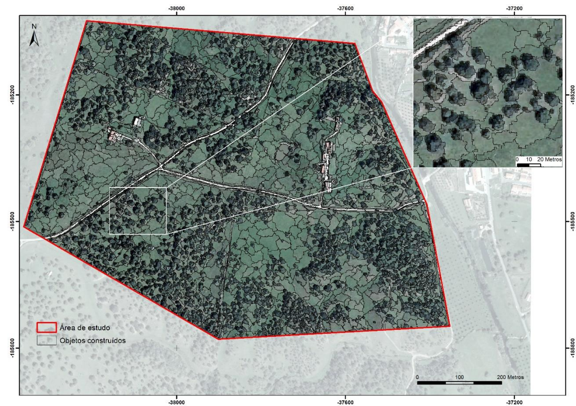
Anexo 6. Objetos construídos na 1ª etapa metodológica, com o algoritmo Multiresolução.
