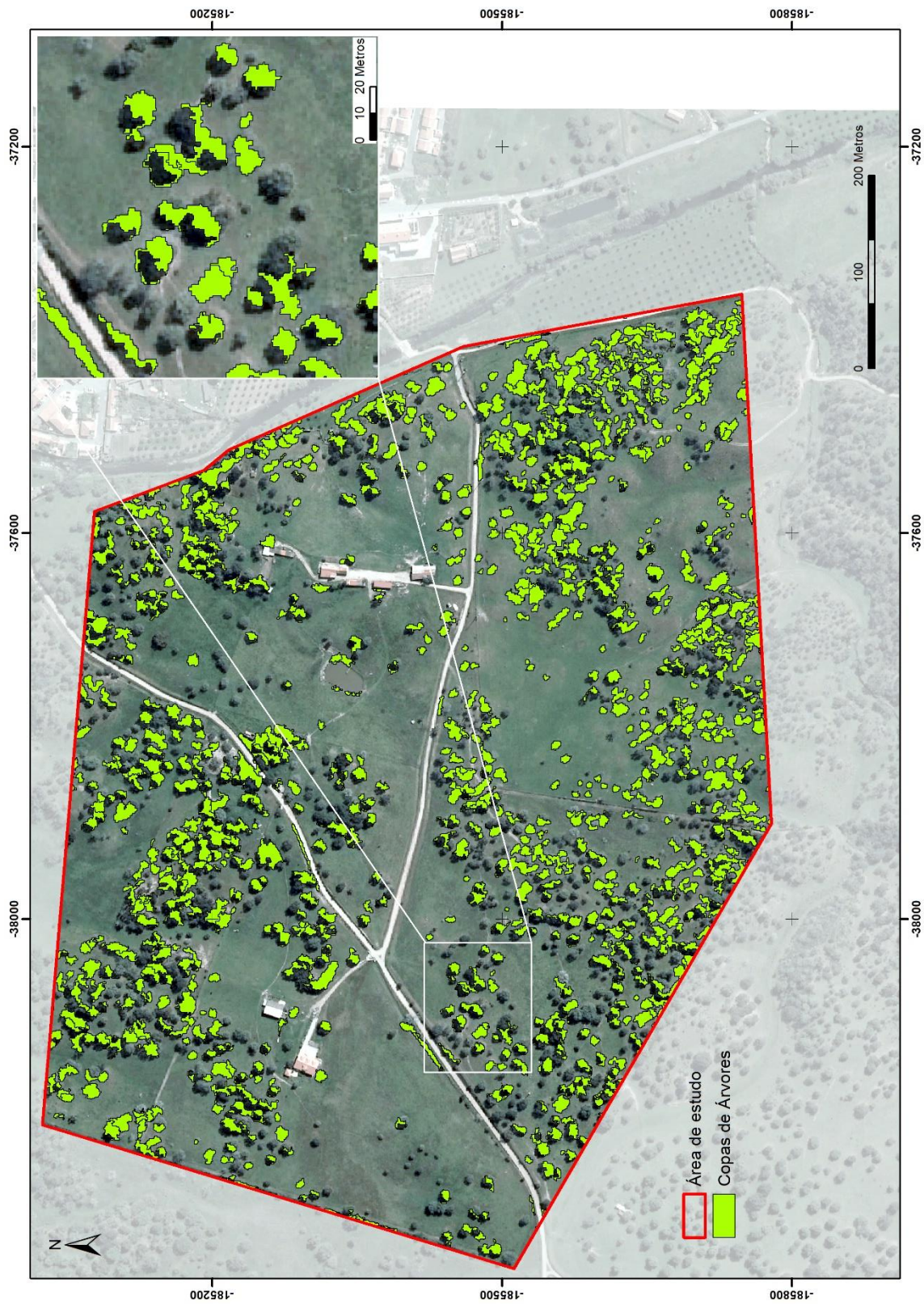
Figura 4.4. Copas de Árvores obtidas através da abordagem que utiliza o algoritmo Multiresolução.
