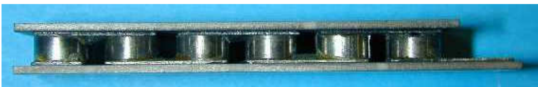
Fig. 6.1. Estructura termoeléctrica en base a material nanoestructurado
