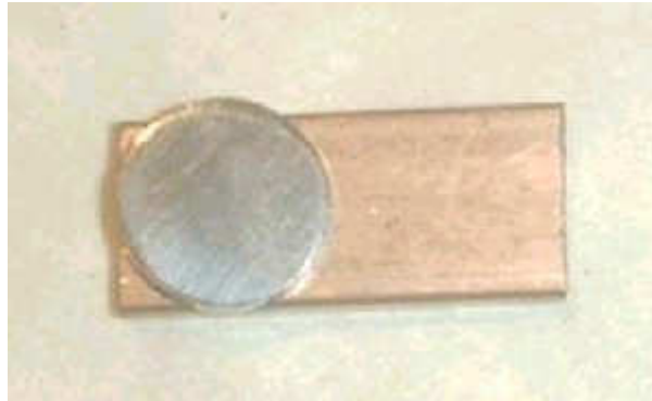
Fig. 5.51. Material \text{CoSb}_3 soldado al cobre
