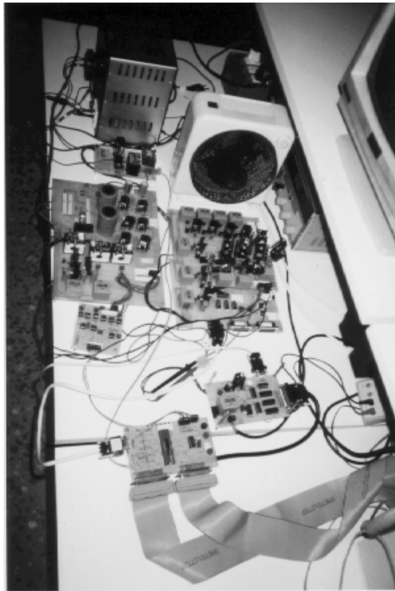
Figura A5.6. Fotografía del convertidor de potencia utilizado para accionar el motor de inducción.
