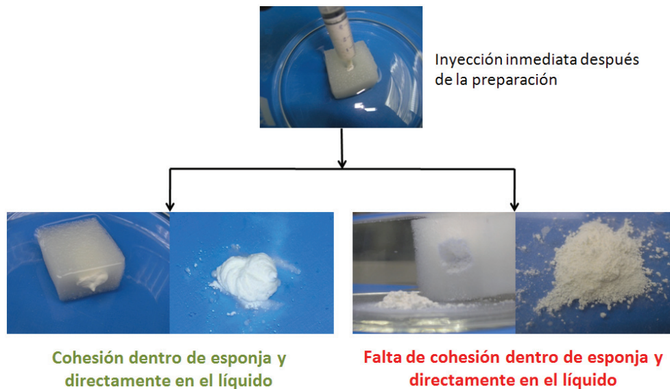
Figura 5.4: Imágenes de las pruebas de cohesión llevadas a cabo y ejemplos de pastas cementantes con y sin cohesión. Arriba: imagen de la inyección dentro de la cavidad de la esponja. Abajo-izquierda: Imágenes de pastas con un índice 4 de cohesión, dentro de la espuma y directamente en medio líquido. Abajo-derecha: Imágenes de pastas con un índice 1 de cohesión, dentro de la espuma y directamente en medio líquido.
