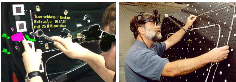
Figura 2.2 Exemples d'utilització de dispositius de realitat augmentada en el món industrial (consorci industrial Arvika, companyia Boeing). Les aplicacions, molt similars, consisteixen en mostrar a un operador informació addicional dels dispositius que manipulant.
