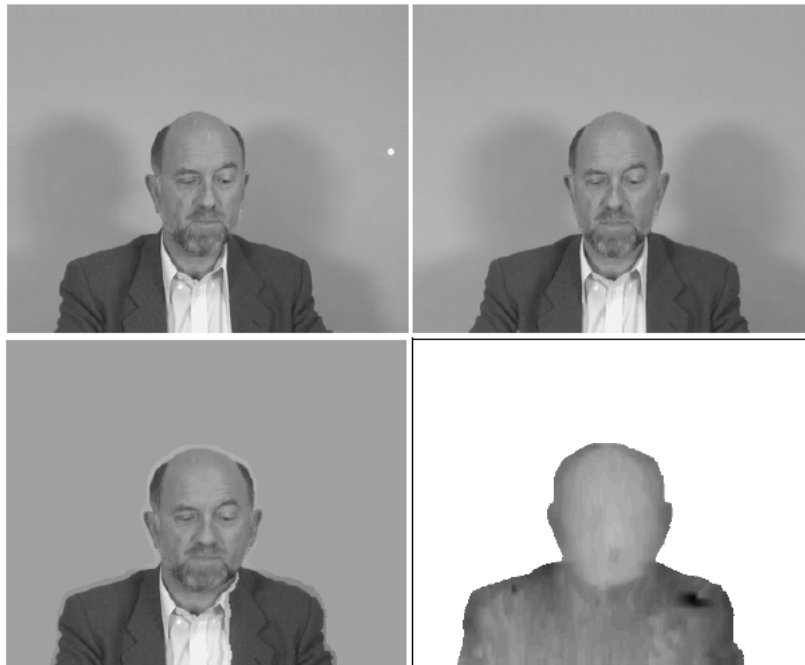
Figura 2.24 Utilització dels compressors comercials de vídeo per codificar els mapes de disparitat en el canal alpha de la seqüència. Les dues vistes superiors són les imatges capturades, la vista inferior dreta és el mapa de disparitat codificat al canal alpha , i la inferior esquerra la informació de textura codificada als canals R,G i B del vídeo.
