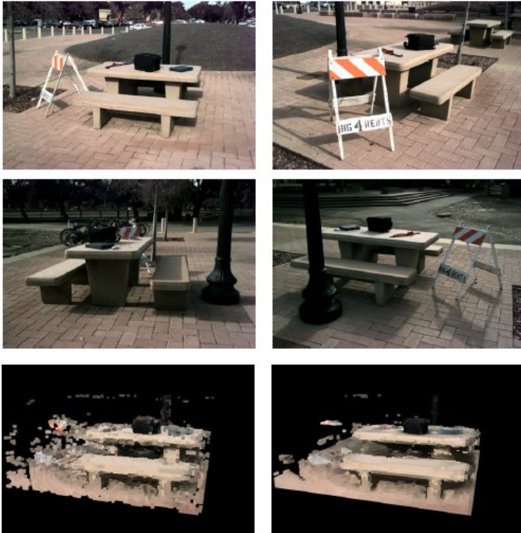
Figura 2.13 Reconstrucció de l'estructura tridimensional d'una escena a partir de quatre vistes de la mateixa (grup superior de vistes), pel mètode de space carving (esquerra) i generalized voxel coloring (dreta).
