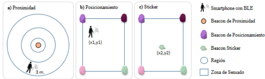
Fig. 1. Ejemplos de tipos de beacons. 1.a) beacon de proximidad. 1.b) beacons de posicionamiento. 1.c) beacon sticker delimitado por beacons de posicionamiento.
