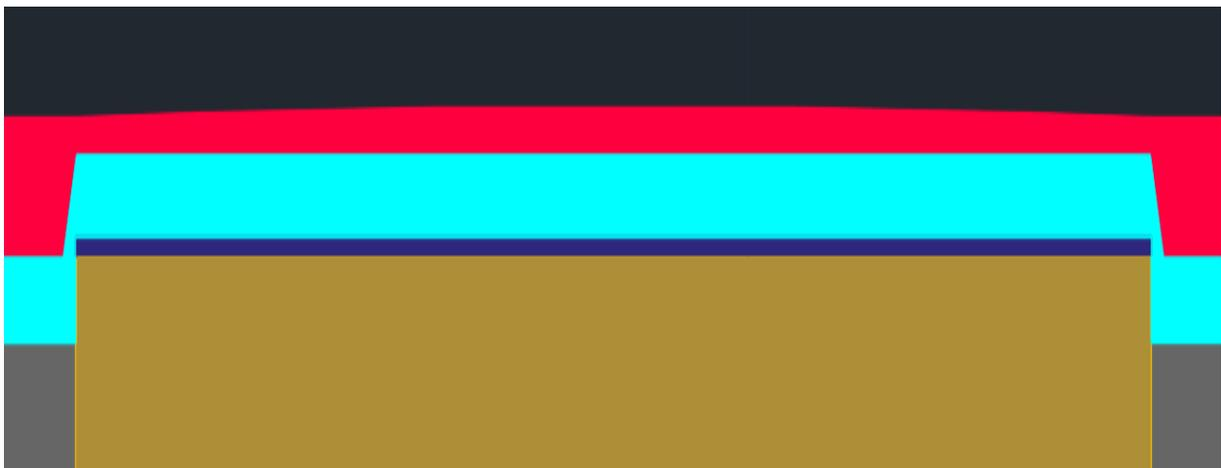
Figure 69 Gravure de la majorité de l'épaisseur de la photorésine avec une sous-étape de gravure RIE agressive à l' $O_2$
