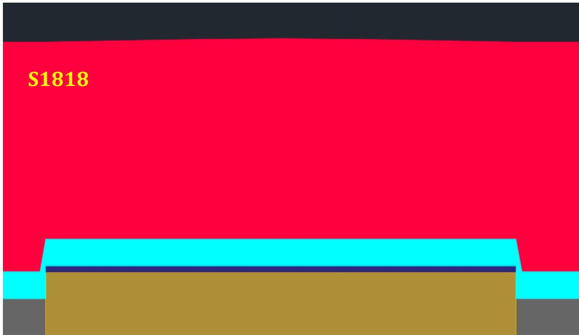
Figure 68 Étalement d'une photorésine peu visqueuse pour planariser la surface
