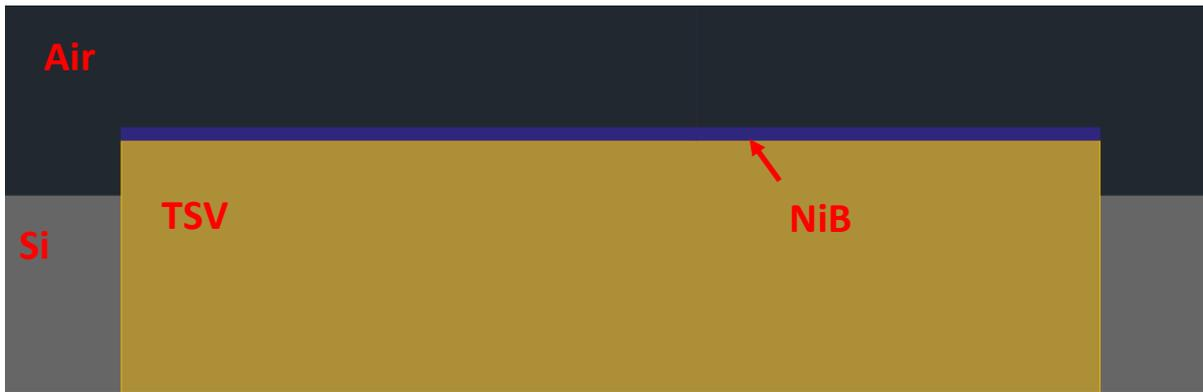
Figure 66 Diagramme en section d'un TSV après l'étape de gravure sélective du substrat
