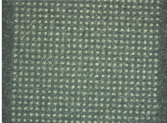
Figure 51 Matrice de TSV révélés au polissage 3  $\mu\text{m}$  au LCSM
