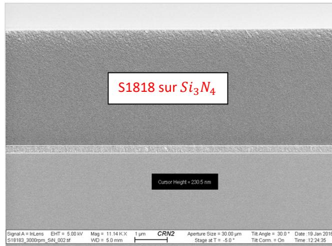
Figure 73 Image MEB de la section d'une couche de S1818 de 2000 nm (haut) sur une couche  $Si_3N_4$  de 230 nm (milieu) sur un substrat de silicium (bas)
