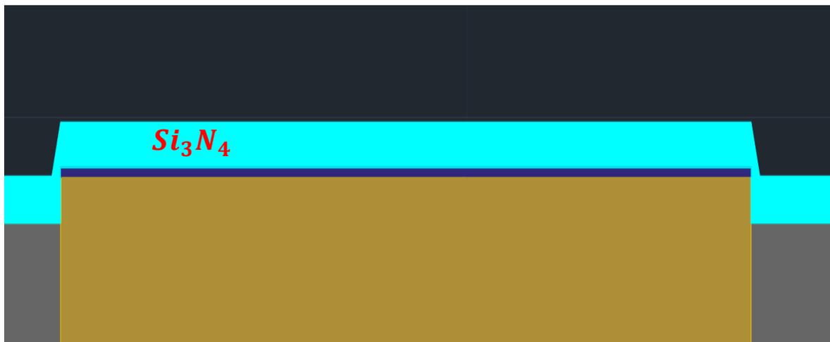
Figure 67 Étape de dépôt d'une couche de  $Si_3N_4$
