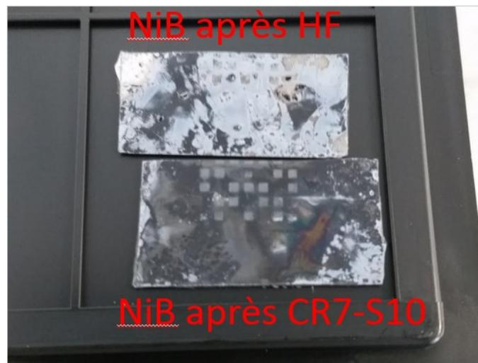
Figure 56 Résultat du placage de NiB sur les puces nettoyées au HF et au CR-7. Le NiB s'est plaqué sur le substrat
