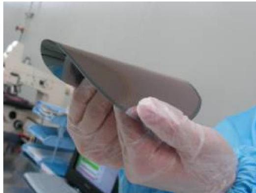
Figure 14 Démonstration des bonnes propriétés mécaniques d'une gaufre amincie par polissage (Long *et al.*, 2006)
