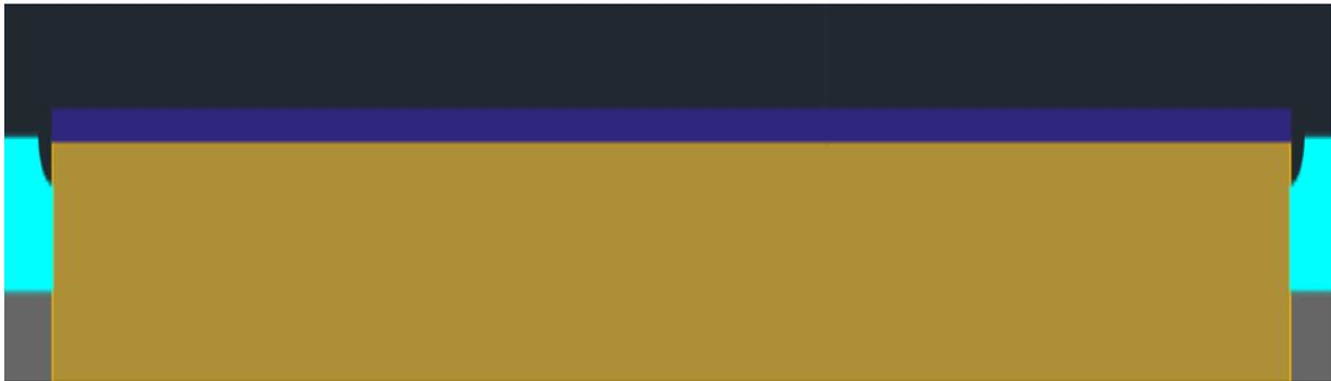
Figure 72 Nettoyage du reste de la photorésine aux solvants
