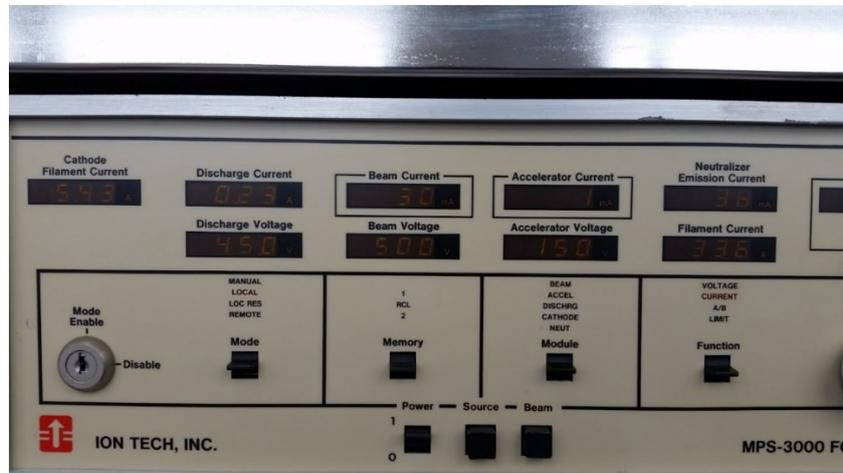
Figure 109 Photo des paramètres de gravure nécessaires pour la gravure de la couche d'amorce
