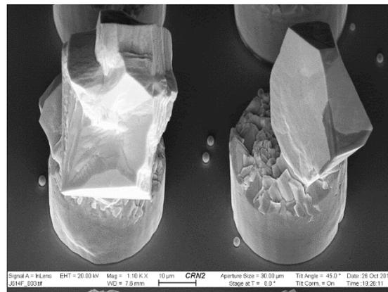
Figure 87 Défauts d'électroplacage de SnAgCu lorsque la solution utilisée est mal préparée
