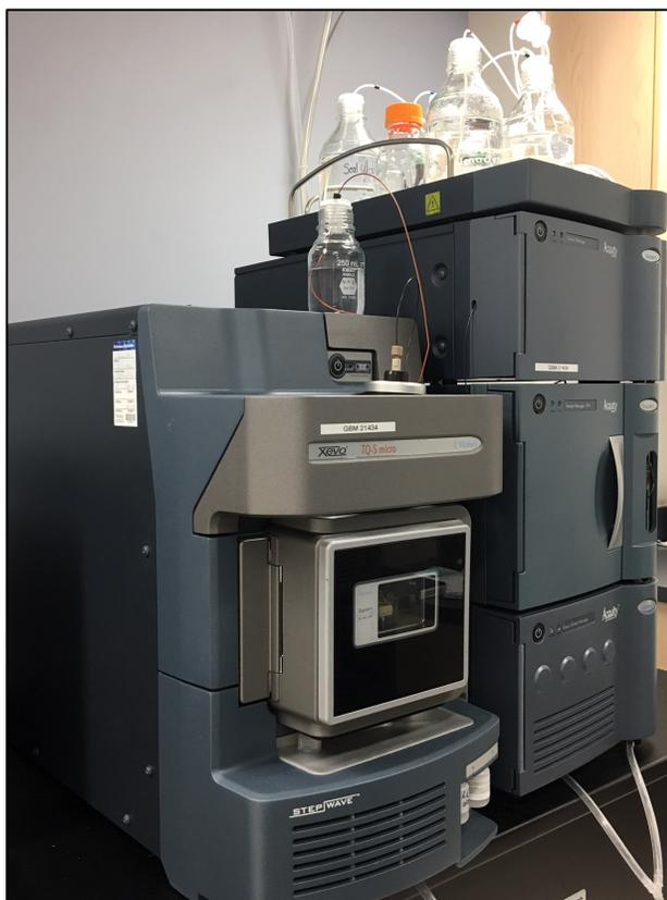
**Figure 14.** Xevo TQ-S Micro, spectromètre de masse en tandem (à gauche) couplé à un système de chromatographie liquide à ultra haute performance Acuity I-Class (à droite) (Waters Corp.)
