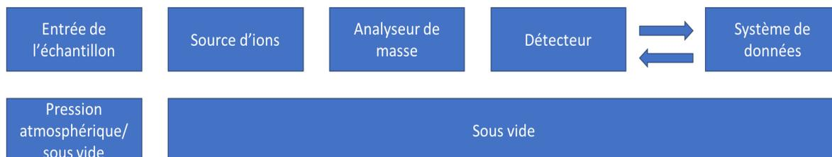
**Figure 13.** Coupe schématique d'un spectromètre de masse (figure adaptée de Gross & Roepstorff, 2014).
