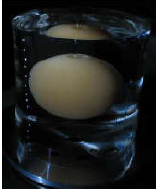
Figure 1.10: Fantôme utilisé dans la première étude DIET. Les points blancs correspondent aux points dont on suit le déplacement [79].
