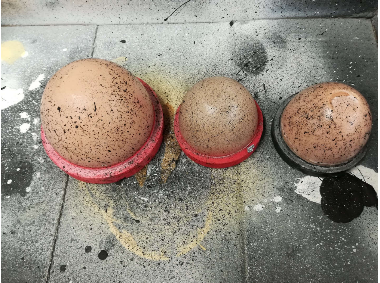
Figure 2.8 : Fantôme avec speckle appliqué. Notez les réflexions crée par l'huile contenue dans la silicone, visible sur le fantôme de droite.
