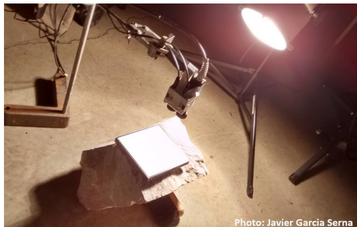
Figure 10 : Acquisition du spectre du Spectralon afin de mesurer le spectre de réflectance relative d'une des roches
