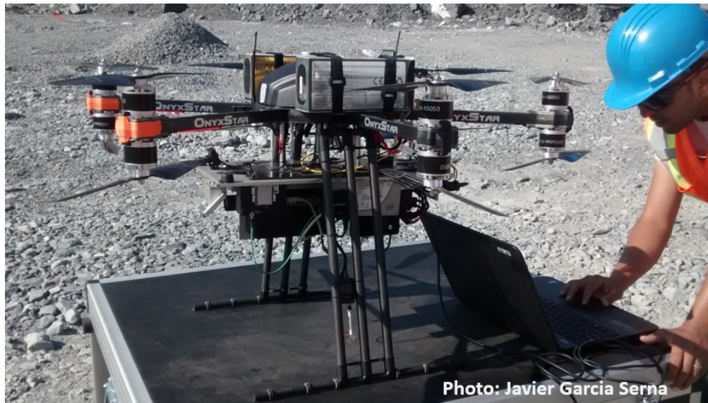
Figure 12 : Aéronef Sans Pilote HYDRA-12 utilisé pour les acquisitions d'imagerie à très basse altitude
