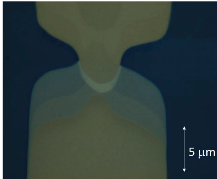
FIGURE 5.2 Photo prise sous microscope avec un grossissement 100\times d'une jonction Josephson faite en niobium et oxyde d'aluminium avec le procédé d'évaporation décrit par la figure 5.1.
