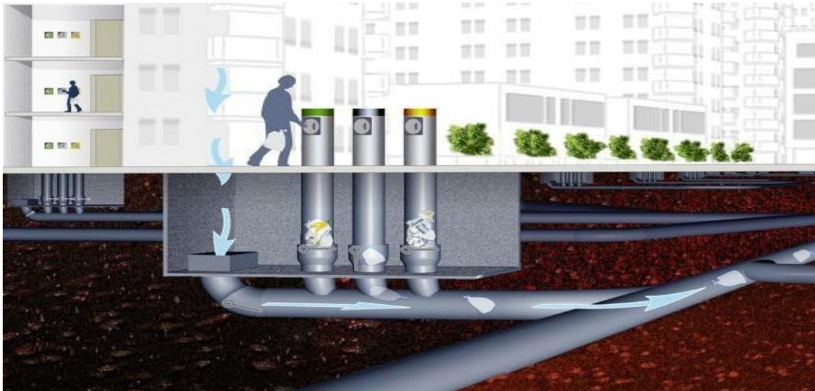
**Figure 4.1 Principe de la collecte pneumatique selon trois catégories (tiré de : voirvert, 2018)**
