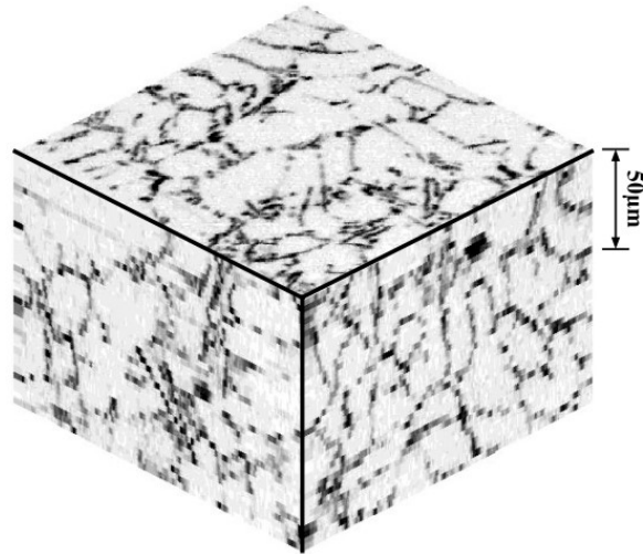
Figure 8: Volume reconstruit d'un alliage Al-Si. Les zones claires sont les phases aluminium (Al) et les zones foncées les phases de silicium (Si) (Alkemper et Voorhees, 2001).
