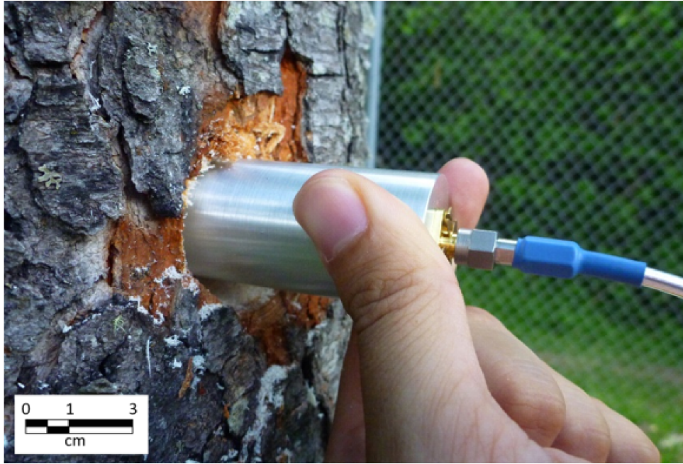
FIGURE 22 – Prise de mesure sur tronc d'arbre avec la sonde coaxiale à terminaison ouverte.
