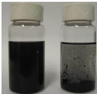
Figure 3.3 : Deux suspensions de SWCNTs dans l'eau DI 24 heures après une dispersion par ultrason. Celle de gauche contient 1%wt de SDS.
