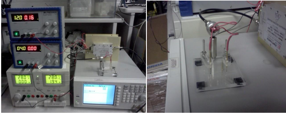
Figure 3.6 : Montage expérimental et banc électronique pour la diélectrophorèse.
