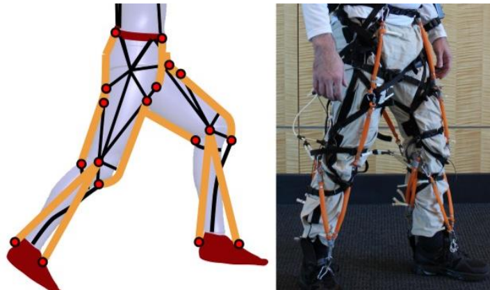
Figure 3. Exosquelette de jambe pneumatique développé par l'Université d'Harvard (le compresseur n'est pas montré) [32]
