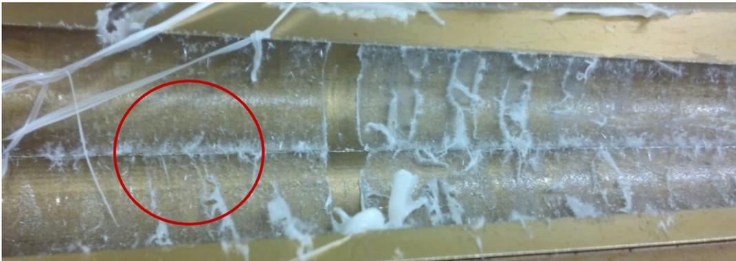
Figure 28 – Photographie de l'intérieur de l'extrudeuse après extrusion du S100\_P20\_C30. On peut y voir des cristaux de caféine.
