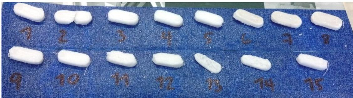
Figure 37 – Dispositifs imprimés avec le filament S100\_T25\_C30. L'essai 2 a été cassé lorsque décollé du plateau d'impression. Les mêmes conditions produisent des résultats différents (12 à 15). La reproductibilité des impressions n'est pas idéale.
