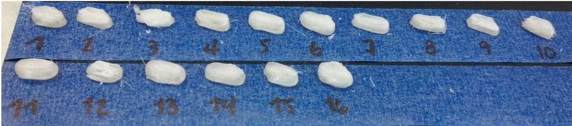
Figure 36 – Dispositifs imprimés avec le filament L100\_T30\_Ø. Les dernières conditions utilisées ne semblent pas produire les meilleurs résultats. Les conditions d'impressions ne sont pas optimales.
