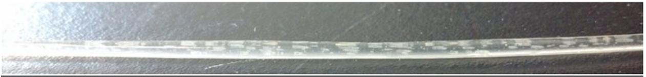
Figure 29 – Filament L100\_T30\_C30, deux semaines après extrusion.
