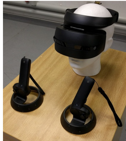
(d) The HP VR1000-100nn Headset and Hand Controllers [45].
