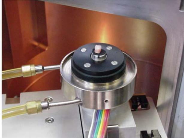
**Figura 15:** Disco osteocondral posicionado en el pedestal del Microscopio Electrónico de Barrido Ambiental antes de ser introducida a la cámara de muestra.
