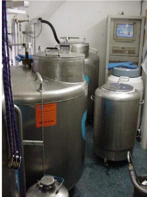
**Figura 8** : Tanques de Nitrógeno líquido controlados por ordenador en el laboratorio de criopreservación de la Corporació Sanitària Clínic.
