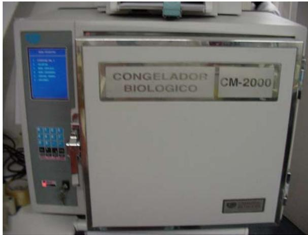
**Figura 12:** Cámara de congelación programable Cryoson ® empleada en el estudio. Laboratorio de criopreservación (Corporació Sanitària Clínic)
