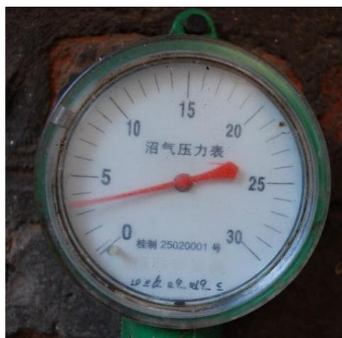
Fig. 9: manomètre utilisé dans les services correctionnels rwandais (RCS) sur les installations de méthanisation. Photo prise le 12.06 à la prison de RUBAVU.
