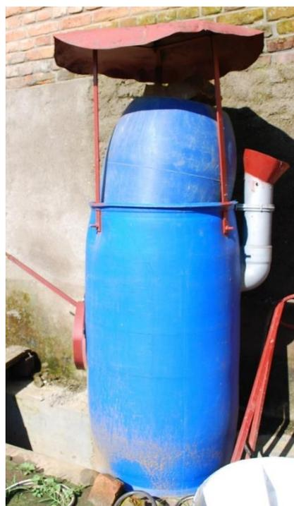
Fig. 20: prototype de digesteur de 200L réalisé par Jose Hoyos dans le cadre de son travail de diplôme en 2016 et laissé en l'état sur le site de l'IPRC-Karongi.
