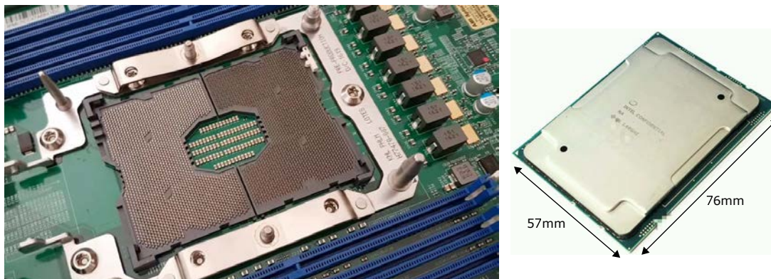
FIGURE 3.34 – Illustrations (à droite) processeur Intel actuel le plus performant (dédié aux serveurs) [15]; (à gauche) son socket avec 3647 contacts
