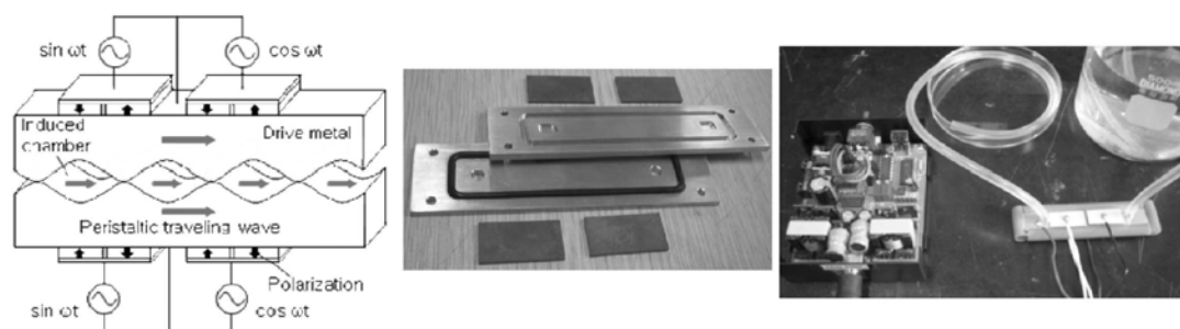
FIGURE 1.11 – Micropompe péristaltique à onde libre présentée par (Kim et al., 2009 [57])
