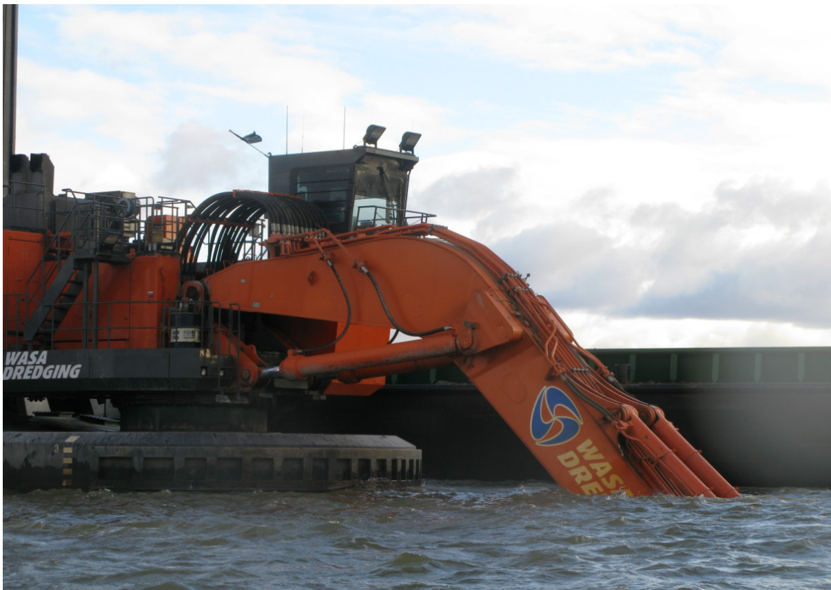
Kuva 22. Laivaväylien ruoppaus ja pohja-aineksen nosto samentaa vettä lähialueella ja aiheuttaa vedenalaista ääntä. Kuva: Lari Veneranta, Luke.
