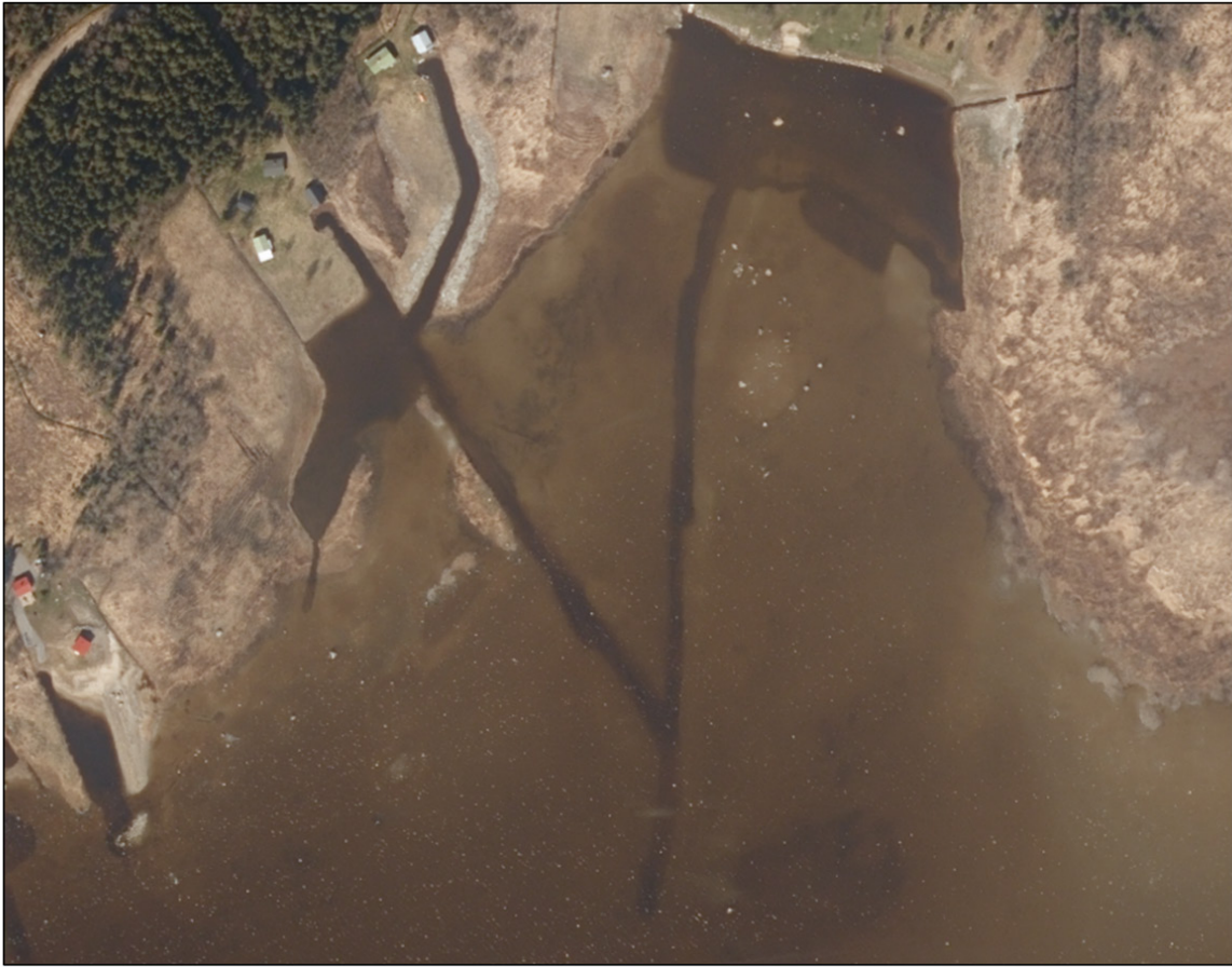
Kuva 20. Ilmakuva ruoppauksen jättämistä jäljistä meren pohjassa. Lähde: Maanmittauslaitos.
