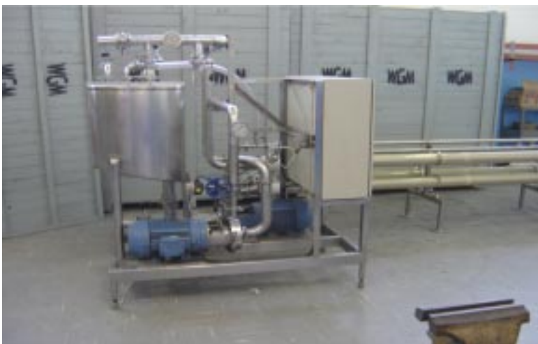
Fig. 4. Sistema de membranas tubulares.
