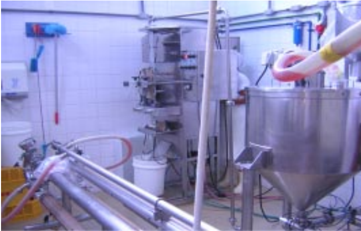
Fig. 5. Suco clarificado permeado sendo recolhido para o tanque de alimentação da dosadora.
