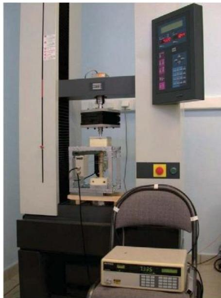
Figures 23 : Photographie du dispositif de mise en compression axiale
