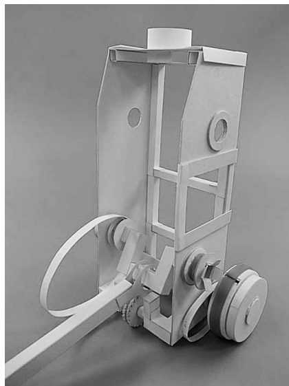
図15 ベルト・ベルト車をクランク軸に取り付け, 胴体部に通す
