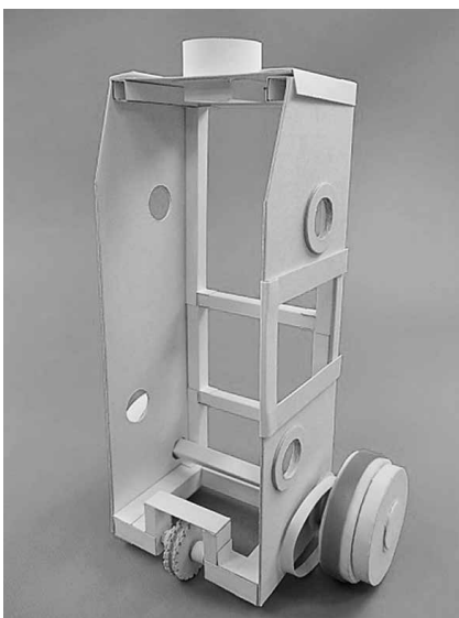
図14 ベルト・ベルト車を車輪, 補強材に取り付ける
