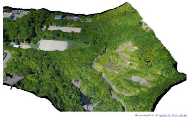
図-6 ドローン撮影画像によるSfM
