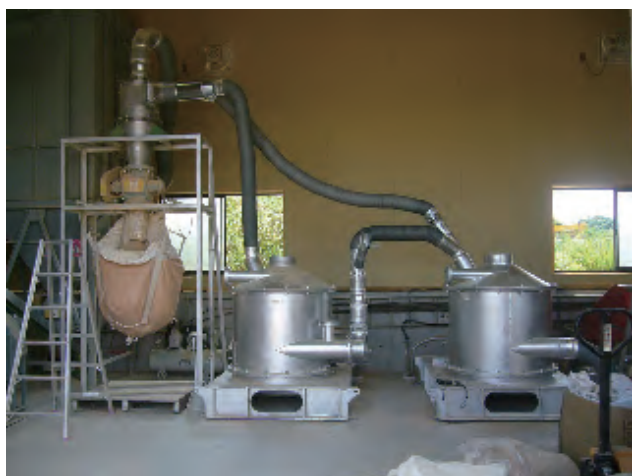
写真1 木質パウダー製造装置
