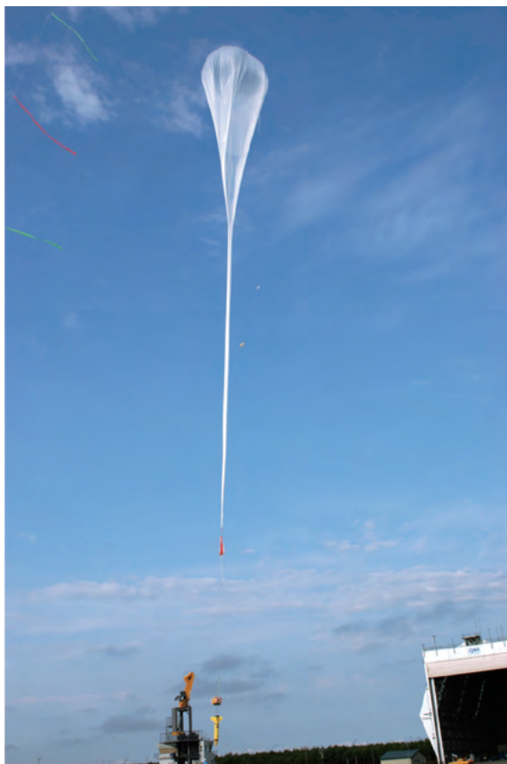
図10 大気球の放球直後の様子。地上(1気圧)では、バルーンはしぼんでいるが、成層圏では直径10m以上に膨らむ。
