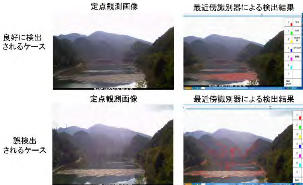
図-8 最近傍識別器によるダム流木の検出結果
