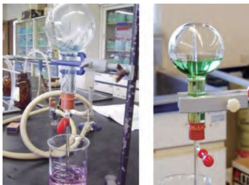
図5 ムラサキキャベツ指示薬を使ったアンモニア噴水実験の様子
