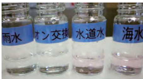
図3 フェノールフタレイン指示薬を使った水的环境調査 左から雨水(和歌山市)、イオン交換水、水道水(和歌山市)、 海水(和歌山市)の色変化の様子。
