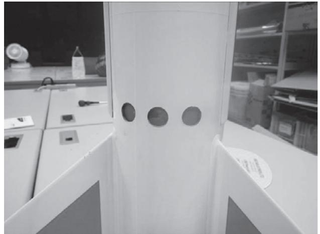
図4 ガス抜き穴
