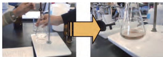
図2 滴定操作における終点の色変化の様子
