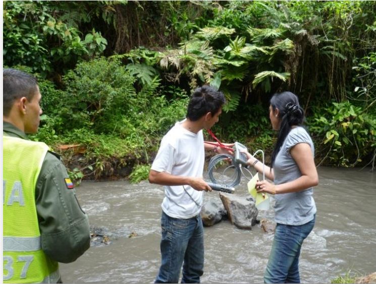
Figura N°9: Georeferenciación en Puntos de Muestreo con Medidor Multiparamétrico y GPS
