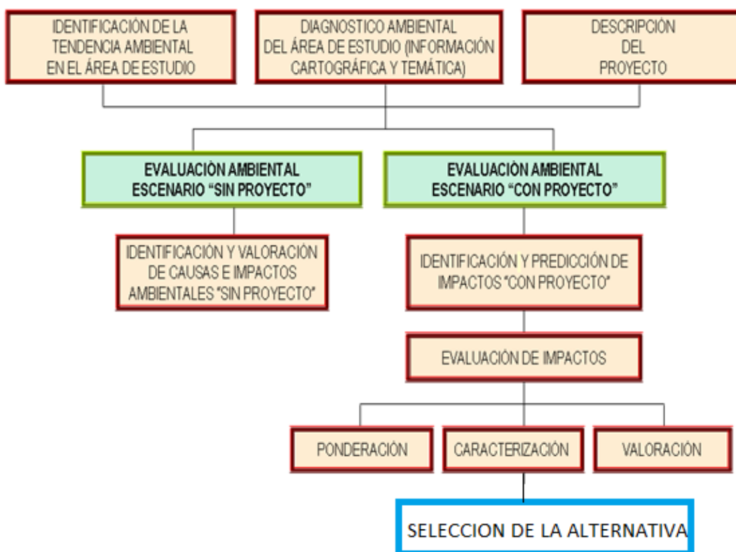
Figura 24. Diagrama metodológico para la selección del nuevo sitio para la escombrera del municipio de Tocaima – Cundinamarca
