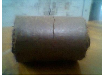
Figura 19. Pellet No. 3 tras cuatro caídas.
