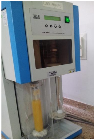
Figura 21. Proceso de digestión en el equipo VELPUDK 132
