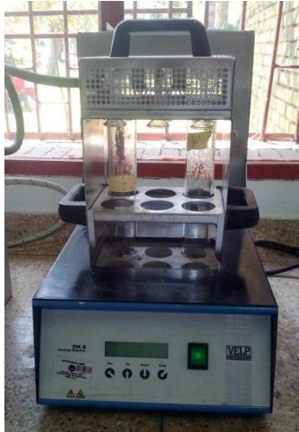
Figura 20. Determinación de nitrógeno total en el equipo VELPDK6.
