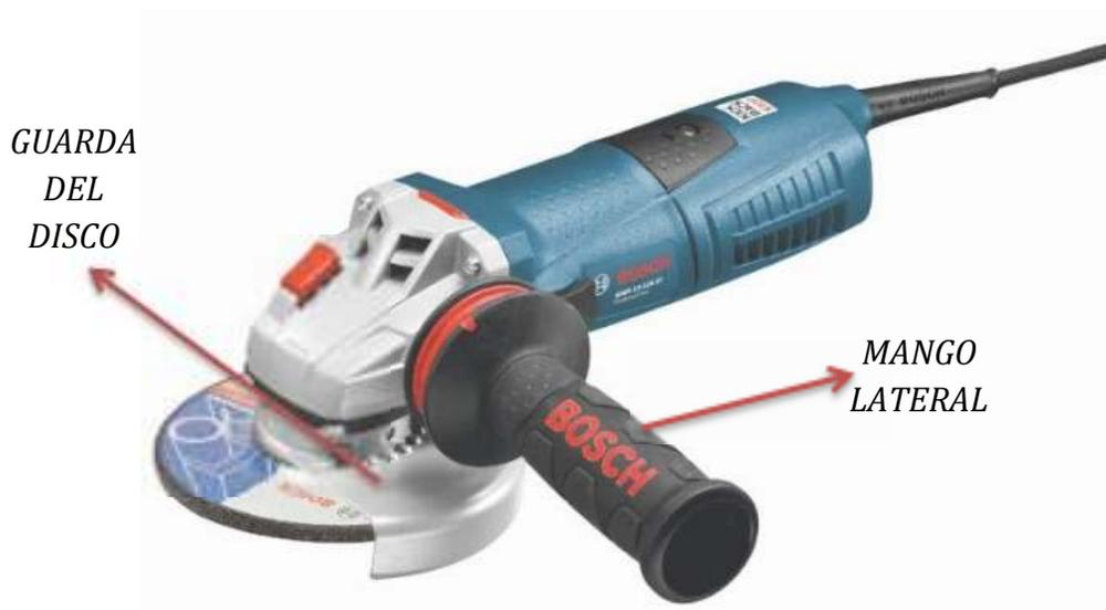
Guarda del disco: Cubierta protectora, evita que el disco de amolar se encuentre expuesto, protege al usuario en caso de rotura del disco y protege al usuario de las partículas expulsadas durante el trabajo. El tamaño de la guarda debe ser mayor al diámetro del disco o muela, ya que durante el trabajo el diámetro de estos puede aumentar debido a la rotación.
