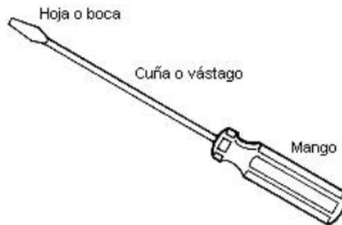
**Ilustración 14. Partes del destornillador**
