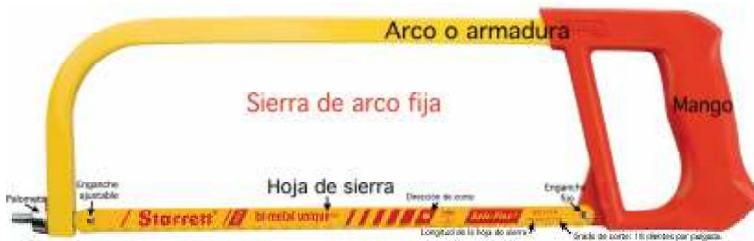
**Ilustración 16. Partes de una sierra de arcos**
