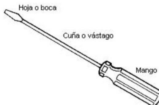
La clasificación más común de los destornilladores tiene que ver con la forma de las puntas. Esta clasificación será la principal condición para la elección final de uno u otro destornillador.
