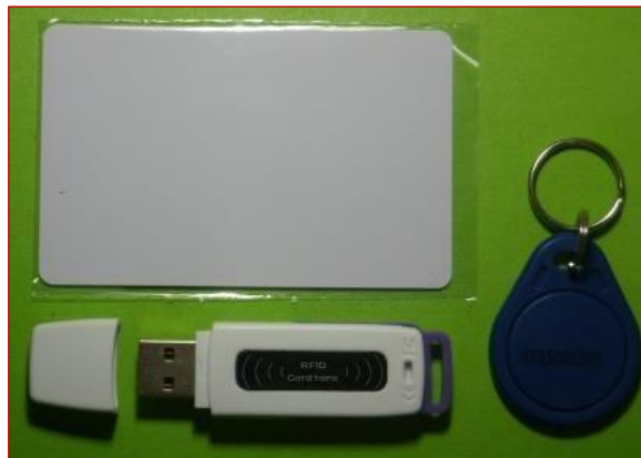
Figura 19: Lector, tarjeta y llavero RFID
