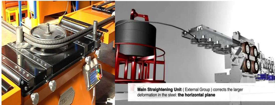
IMAGEN 8 Proceso de enderezado, corte y doble. 58
