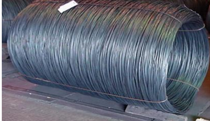
IMAGEN 19 Embalaje, Bobina de 1.5 Toneladas.
