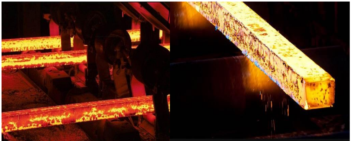
IMAGEN 1 Proceso de laminación en caliente para producir Palanquilla de acero 6 , sección transversal 130X130 mm y Longitud de 12mts
