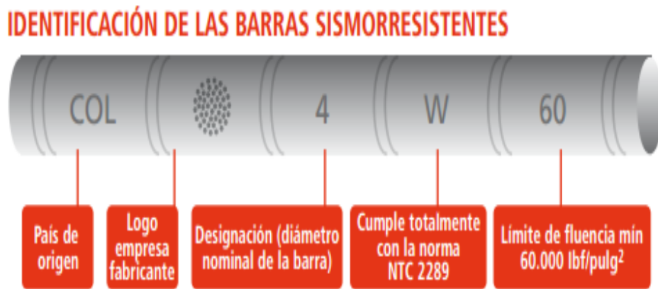
IMAGEN 16 Identificación de barras corrugadas G-60
