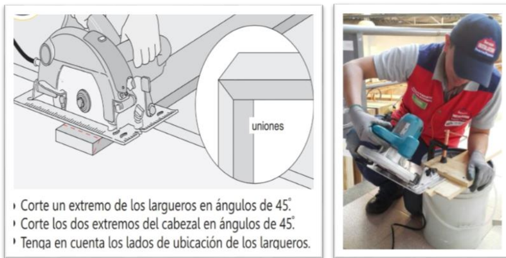
Imagen 7 y 8: Corte a 45 grados Fuente: Suministrada por la compañía
