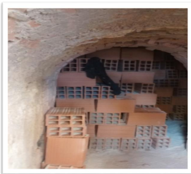
Figura 33. Extracción de Bloque de Arcilla cocido en horno Hoffman semicontinuo en Ladrillera Los Cristales
