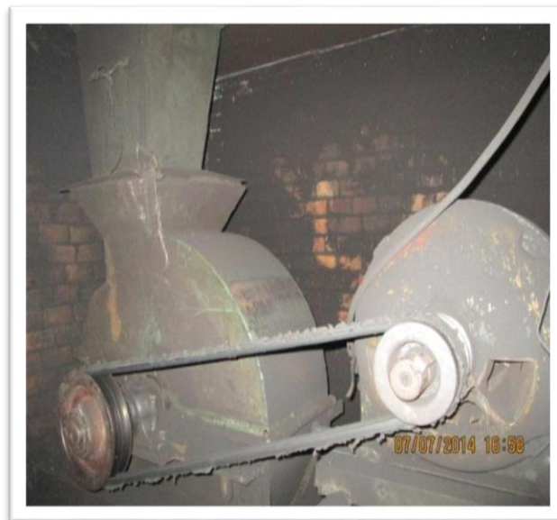
Figura 28. Molino de carbón en Ladrillera Los Cristales
