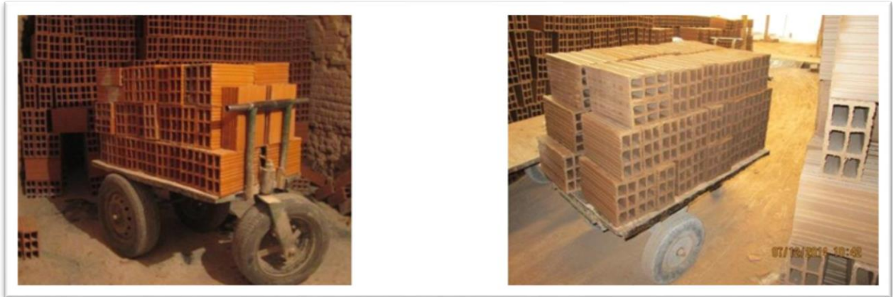
Figura 25. Llenado de horno con bloque de arcilla seco en Ladrillera los Cristales
