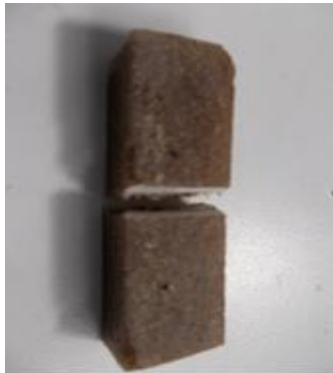
Ilustración 36 Probetas normalizada ASTM D256
