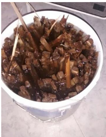
Ilustración 15 Listones de guadua en proceso de extracción de la parte exterior Fuente: Autor del proyecto
