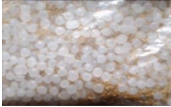
Ilustración 27 Mezcla de pellets de poliuretano y material de refuerzo. Fuente: Autor del proyecto
