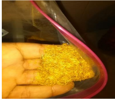
Ilustración 26 Fibra con tratamiento de mercerizado al 5% Fuente: Autor del proyecto
