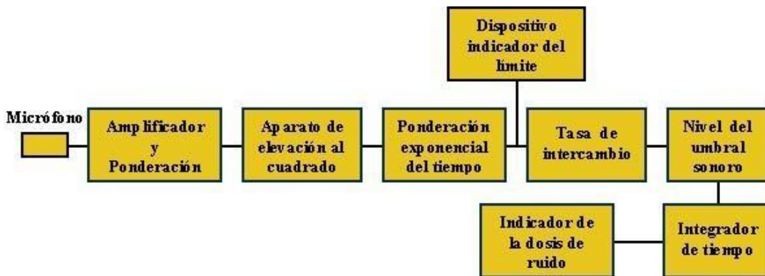
Figura 11. Esquema de un sistema de medición de ruido por dosimetría
