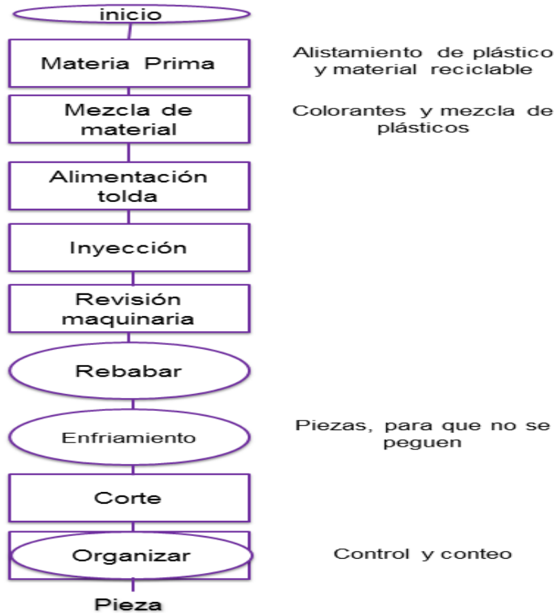
Gráfica 20. Diagrama de flujo del proceso de piezas plásticas
