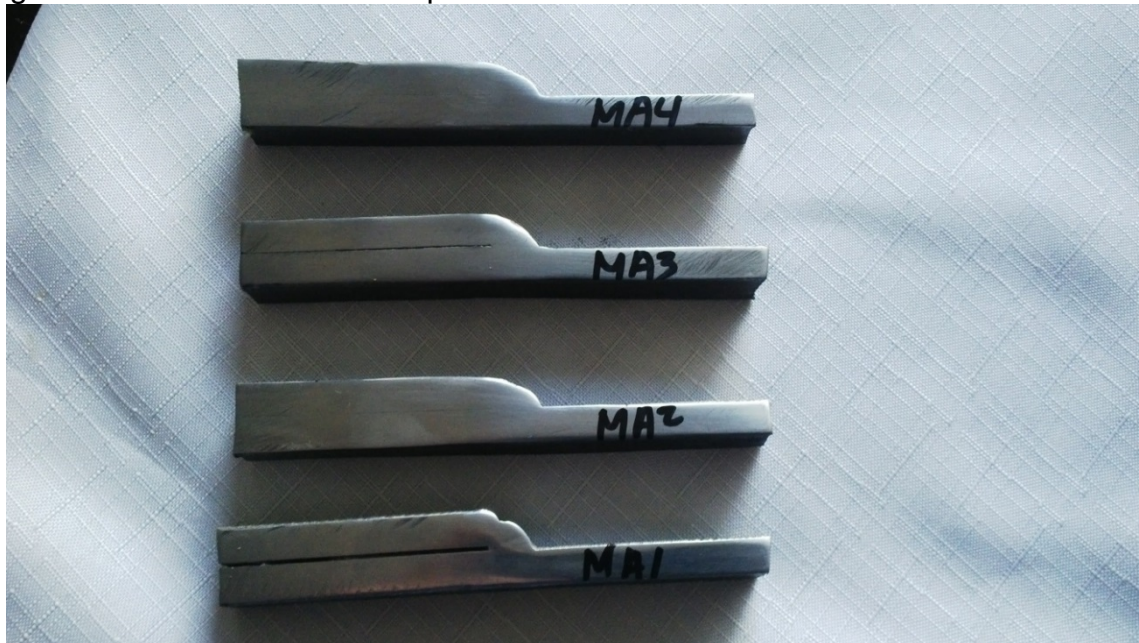
Figura 35. Probetas Macro ataque Junta Camisa
