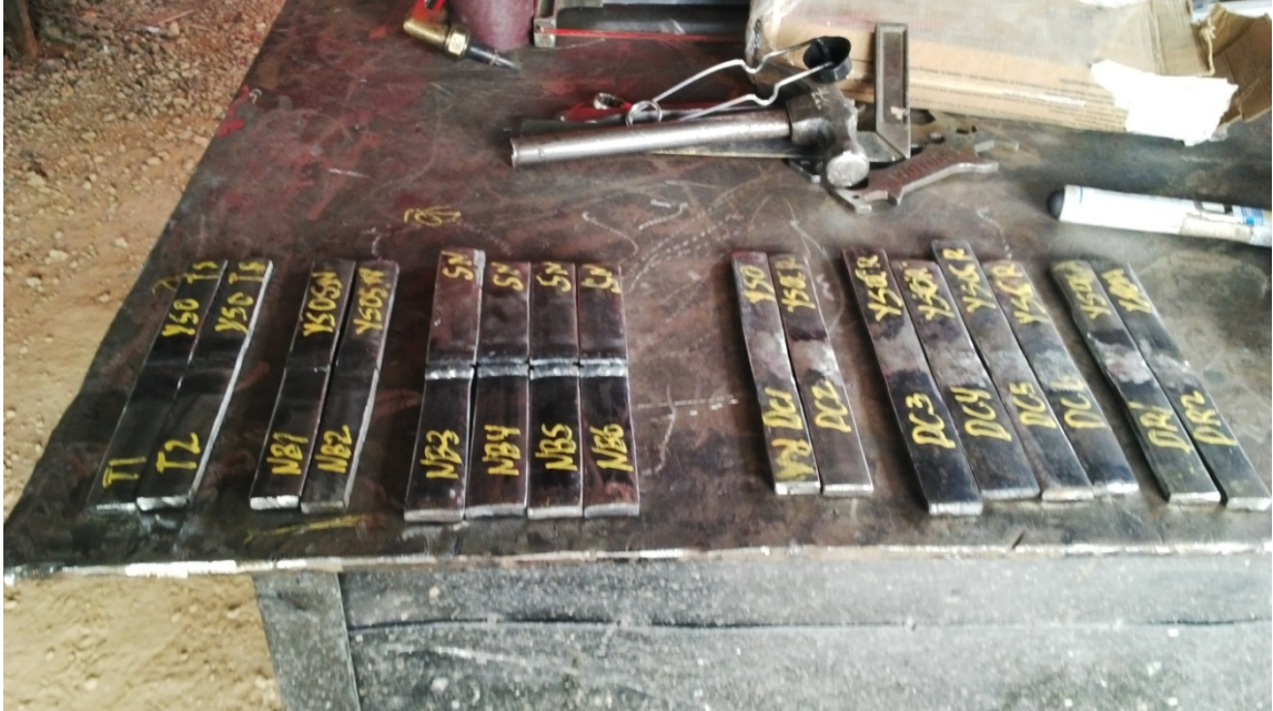
Figura 36. Probetas para Ensayos Mecánicos
