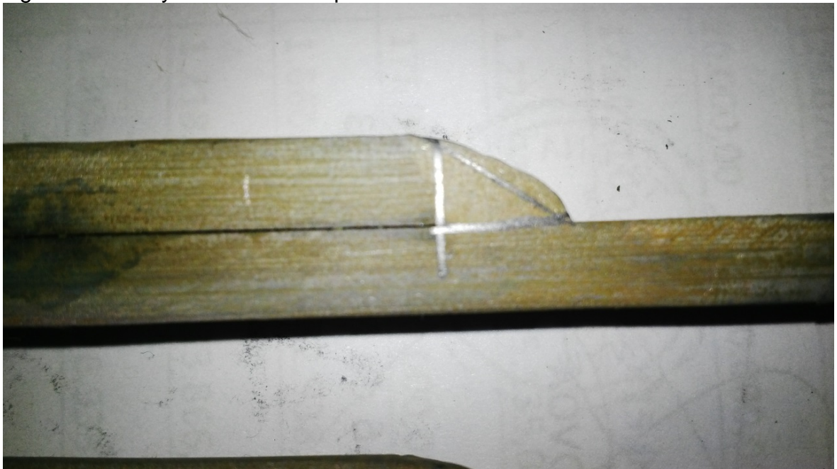
Figura 41. Ensayo de Macro Ataque – Medición de Catetos
