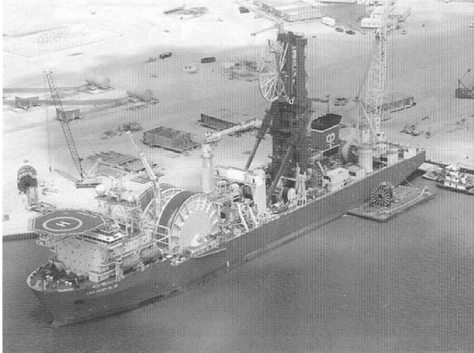
Figura 12. Embarcación de carrete vertical (J-lay) 29
