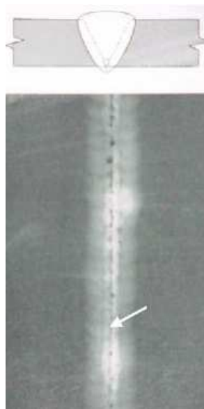
Figura 8. Porosidad alineada en el cordón de la raíz
