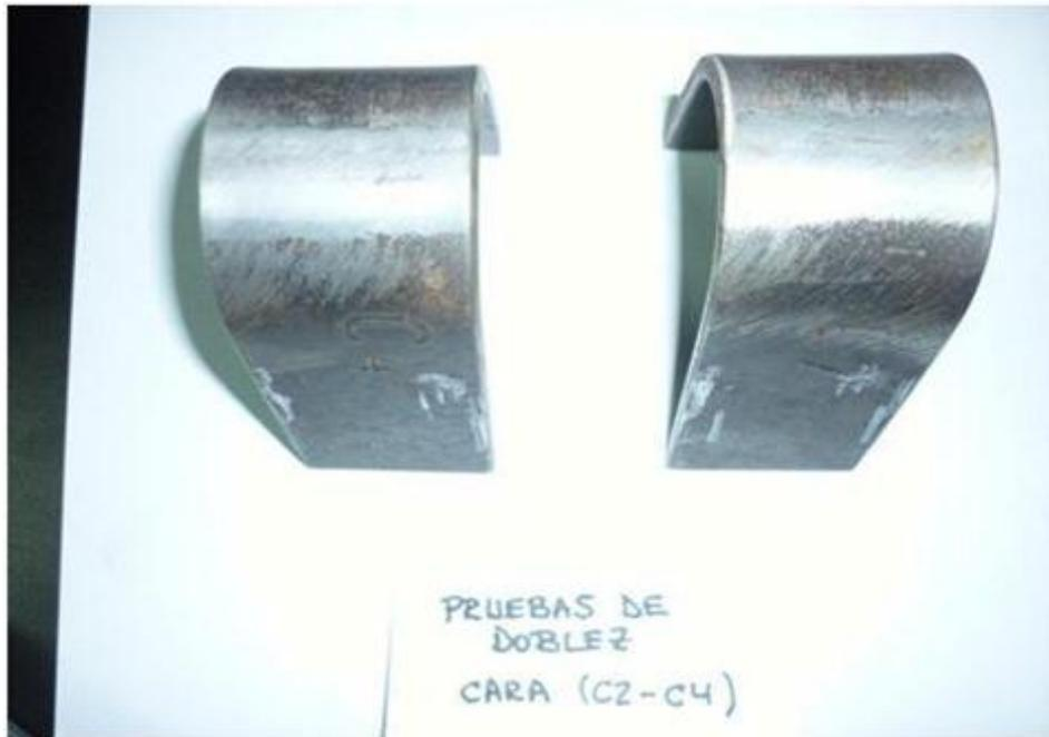
**Figura 27.** Prueba de doblamiento guiado de cara
