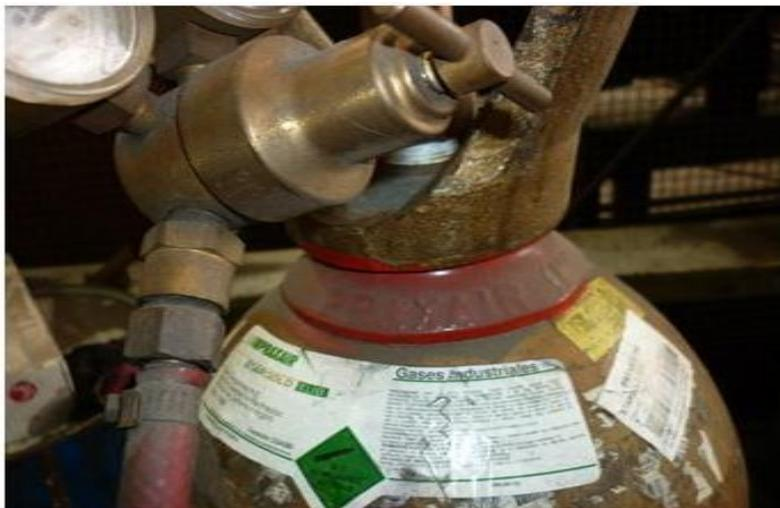
**Figura 7.** Mezcla de gases utilizados, Argón- CO2
