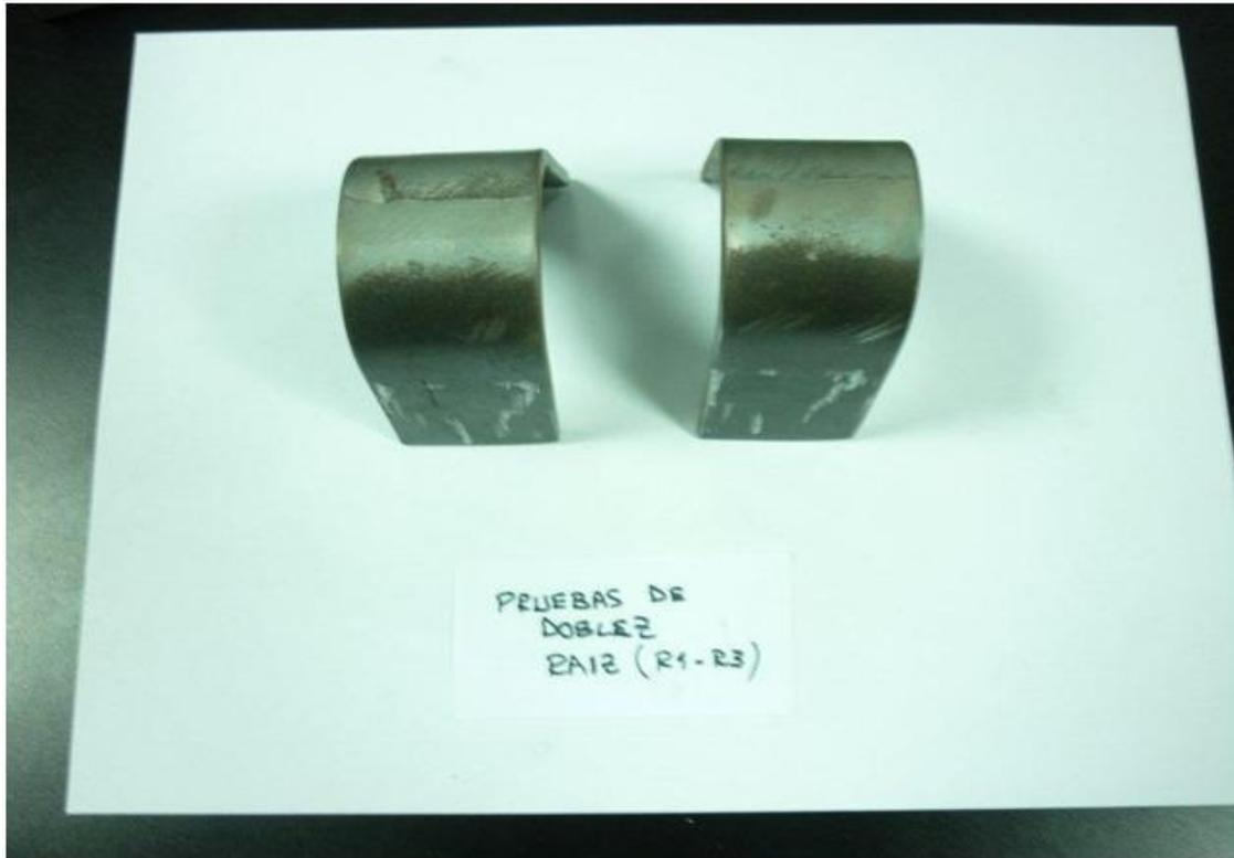
**Figura 24.** Prueba de doblamiento guiado raíz (R1-R3)
