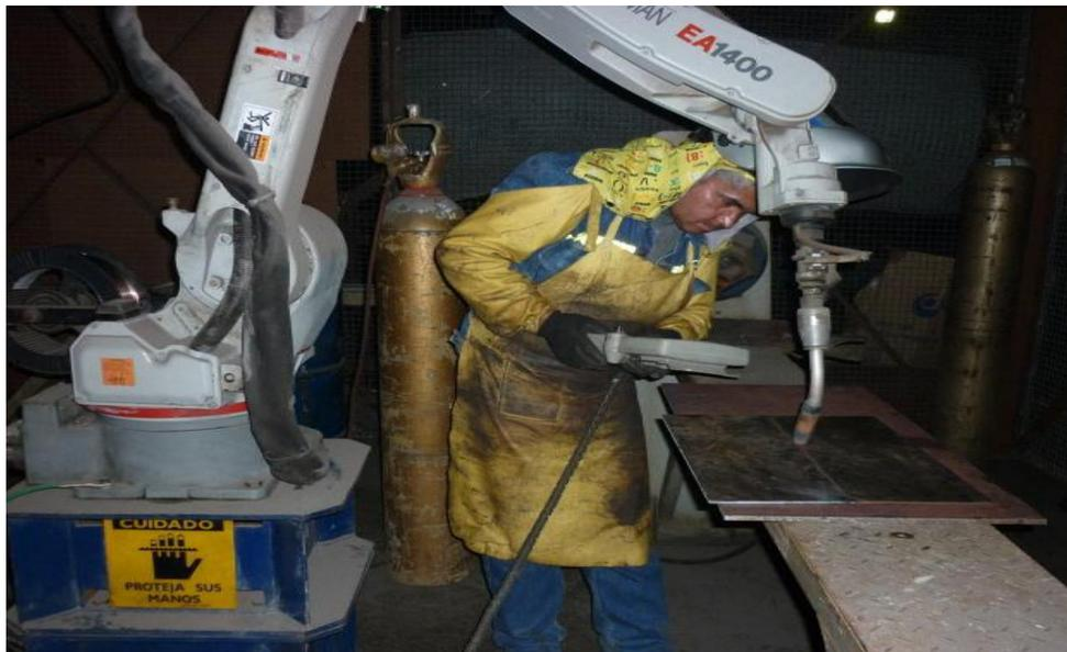
**Figura 12:** Verificación de las coordenadas (programación)
