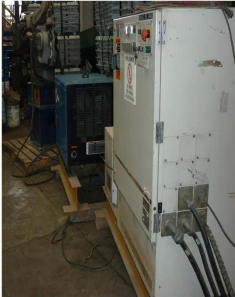
**Figura 5.** Prueba y puesta a punto de los equipos auxiliares: fuente de poder y controlador.
