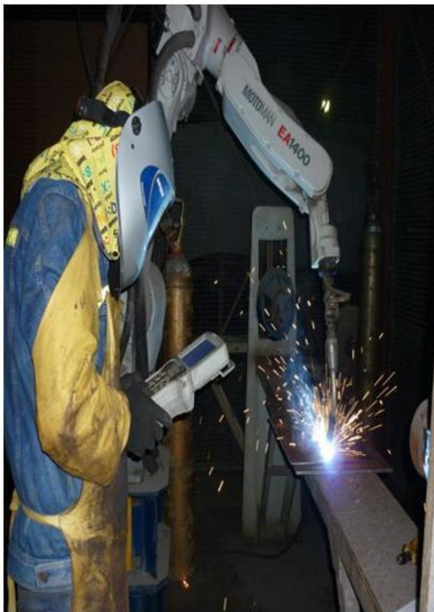
**Figura 13.** Robot iniciando el proceso de soldadura.
