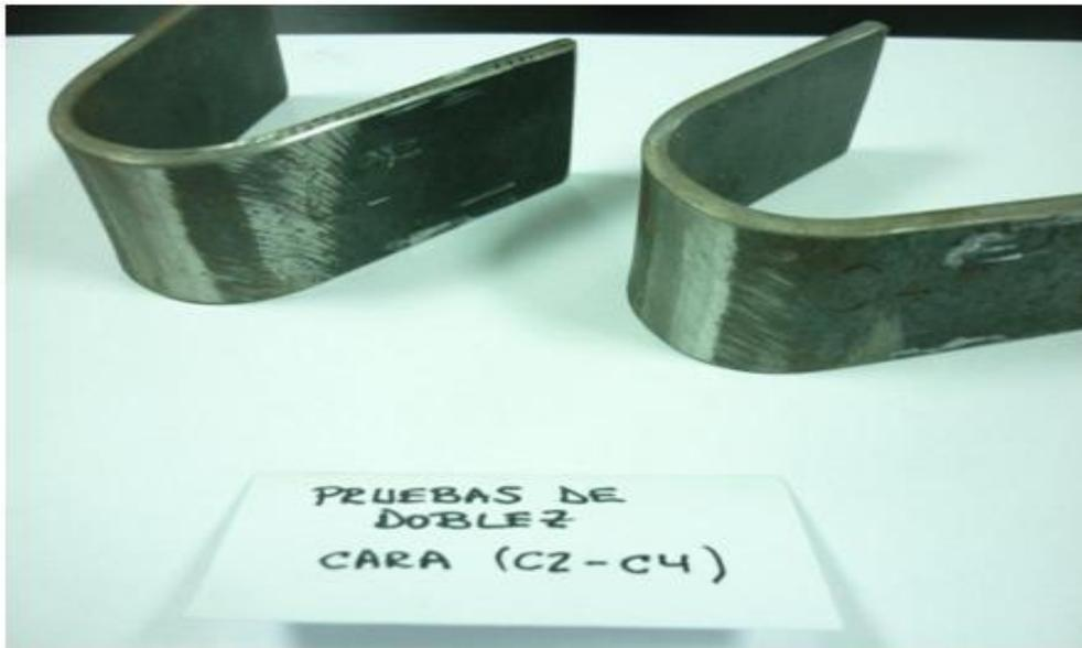
**Figura 26:** prueba de doblez de cara (C2-C4)
