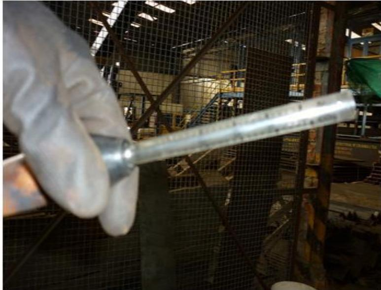
**Figura 8.** Medición del caudal de la mezcla del gas protector
