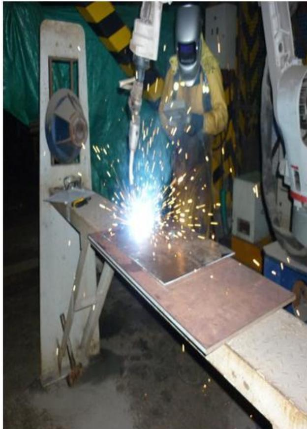
**Figura 14.** Robot avanzando y finalizando el proceso de soldadura.
