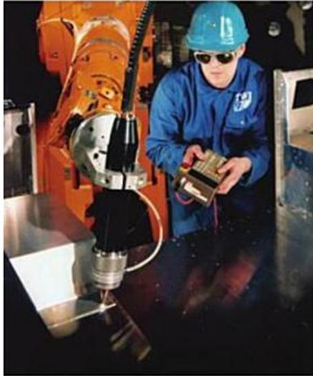
Figura 2: soldadura robótica con el proceso GMAW.
