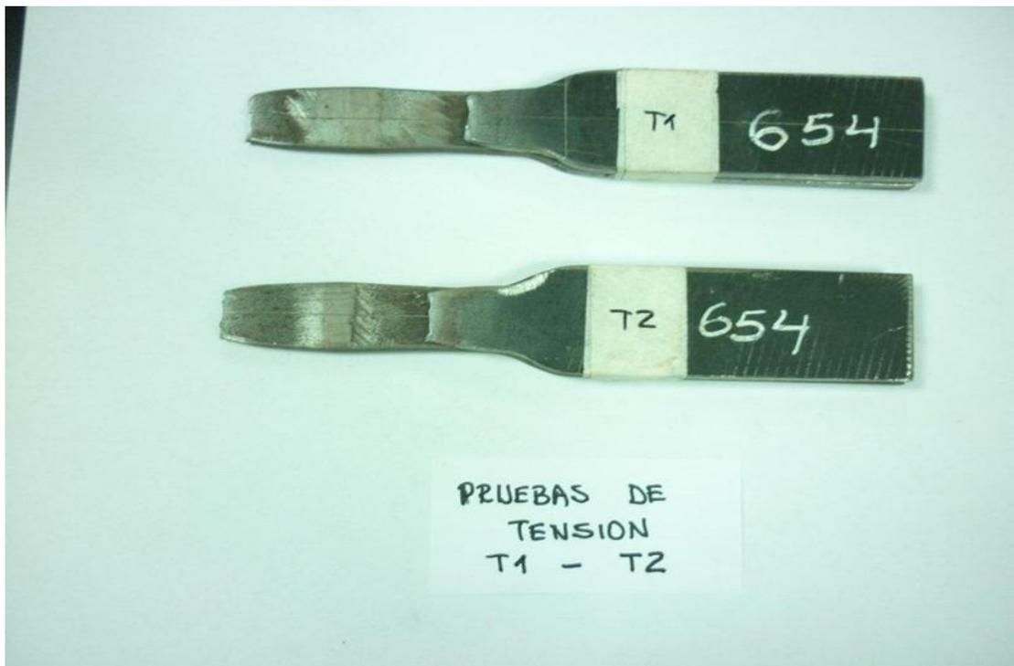
**Figura 23:** pruebas de tensión (probetas T1 y T2).
