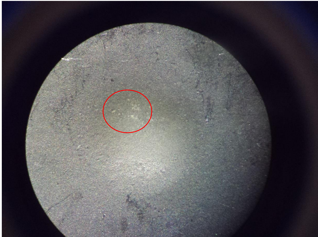
Probeta Templada Con Desgaste - 6 Minutos
