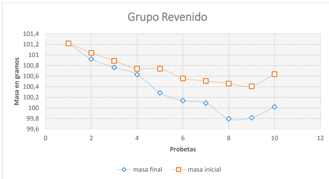
Ilustración 34 Medición de masa antes y después del ensayo por probeta Revenida
