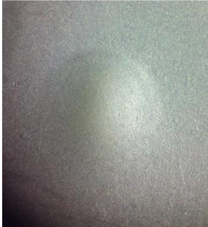
Probeta Bonificada Con Desgaste - 6 Minutos
